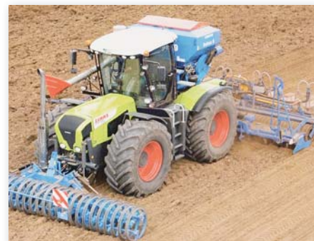
Рис. 1. Комбинированный агрегат при предпосевной обработке почвы и посеве овощных культур
