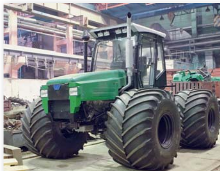
Рис. 3. Аروحные шины на тракторе для снижения давления на почву и использования на слабонесущих грунтах
